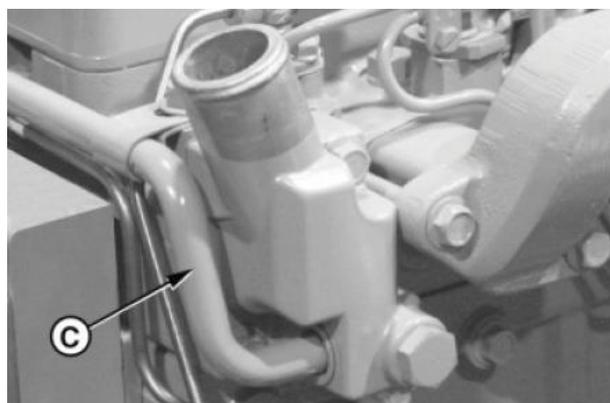
С – Соединения системы распределения температур
