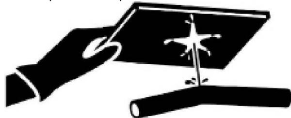
ПРИ ПРОВЕРКЕ УТЕЧКИ ЖИДКОСТИ ИСПОЛЬЗУЙТЕ КАРТОН
