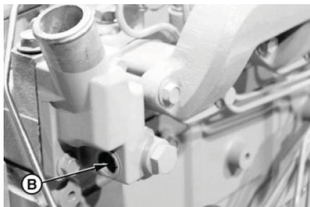
Рис – Уплотнитель крышки термостата
