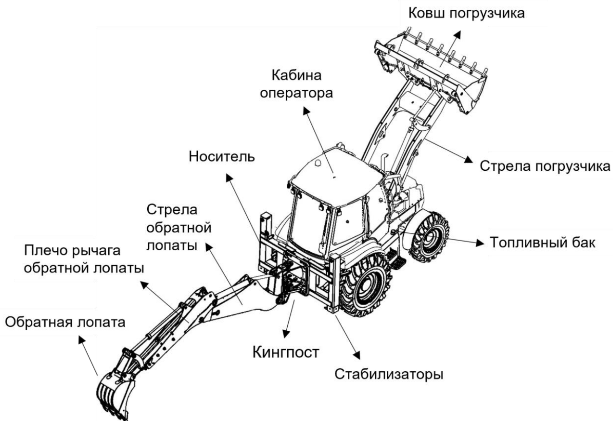
Фигура 1.4. Основные компоненты экскаватора-погрузчика
