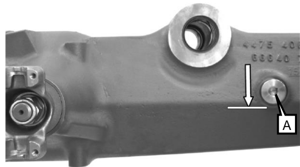
Фигура 5.72. 102В заглушки передней оси (ZF)
