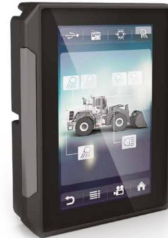
Hidromek Opera – это интерфейс, который облегчает взаимодействие между оператором и машиной. Оператор может легко переходить между меню в Opera, проверять состояние машины и изменять настройки.
